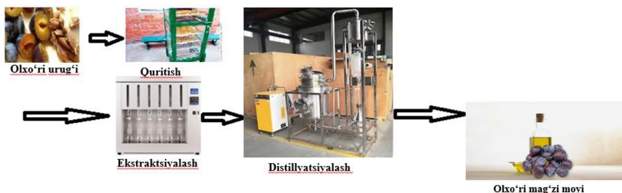
1-rasm. Ekstraksiyalash usuli bilan olxo'ri moyini ajratib olish texnologiyasi.
